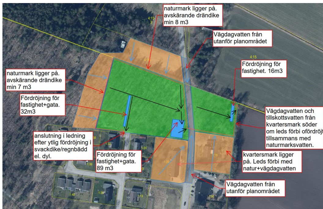
Bild 4.3 Skiss visande tänkt utformning dagvattensystem inom området. Goda förutsättningar finns för placering av yttlig fördröjning samt till viss del infiltration som kompenserar för ökade utflöden.
